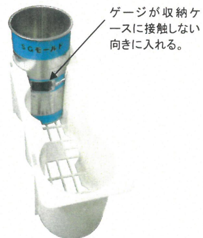
図-2 型枠のケース収納状況
